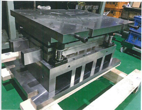
▲精密プレス金型の一例。プレス加工に使用する金型を独自に製作できるのが、同社の強み。
