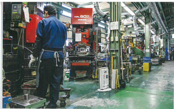
▲6台のプレス機が稼働するプログレッシブ(順送)型プレスラインは、今夏から110tプレス機を導入予定。コイル状の材料を順次送り、単一の金型で複数のプレス加工工程を自動で行う。
